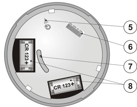
Abbildung 2: 5 – Ausrichtungspfeil/ Logo; 6 – Produktionsnummer; 7 – Sabotagesensor; 8 – Batteriefach
